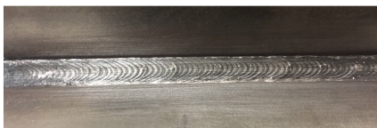
图4 宏观焊缝表面成形良好
