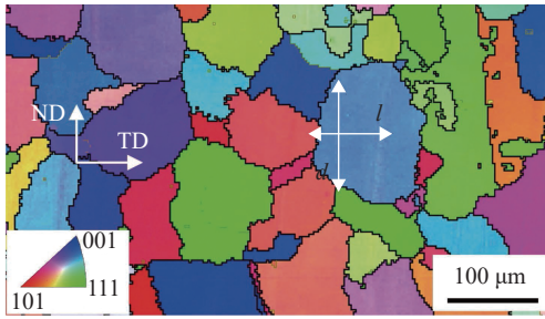
(a) 电弧焊-焊缝区
