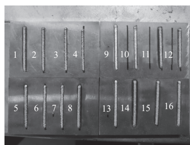
图2 不同试样 JG-11 单道熔覆涂层表面形貌
