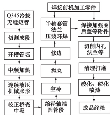
图1 驱动桥壳整体复合胀形工艺流程图
