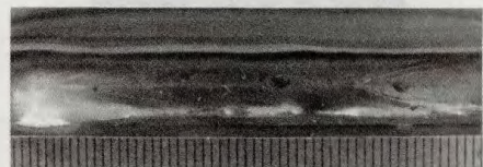
图 11 激光-GMAW 复合双面横焊无侧壁未熔合焊缝图像
