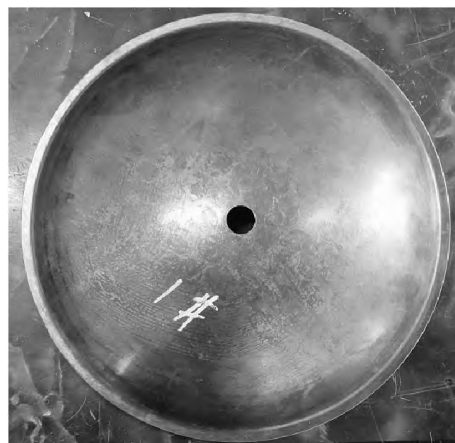
图 15 最终成形隔碗零件
