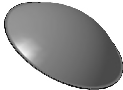
b 带工艺补充面的隔碗零件
