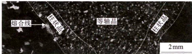
图 4 焊缝区域阳极覆膜形貌
