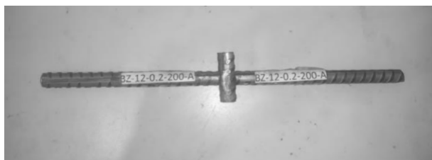
图 1 焊网钢筋典型试件
